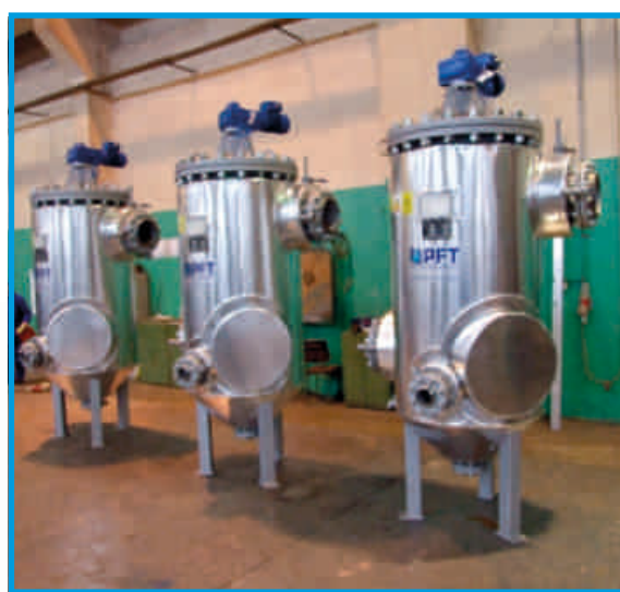
Самоочищающийся фильтр DN100 тяжелого топлива (гудрон) с системой очистки средствами, подаваемыми извне.
