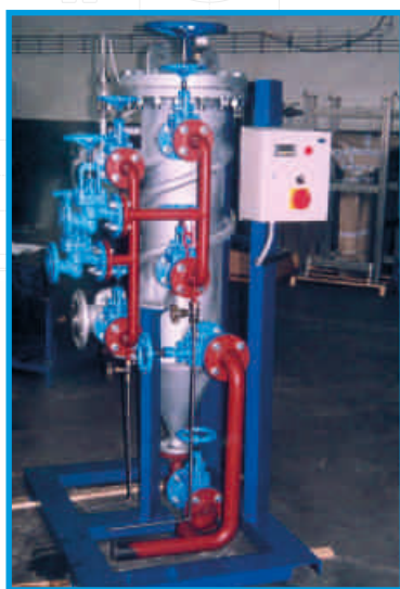
Самоочищающийся фильтр DN100 тяжелого топлива (гудрон) с системой очистки средствами, подаваемыми извне.
