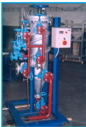
Filtr samoczyszczący DN 100 paliwa ciężkiego-gudron z układem płukania czynnikami zewnętrznymi.
