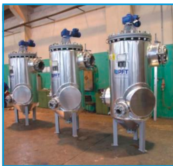
Filtr samoczyszczący DN 100 paliwa ciężkiego-gudron z układem płukania czynnikami zewnętrznymi.
